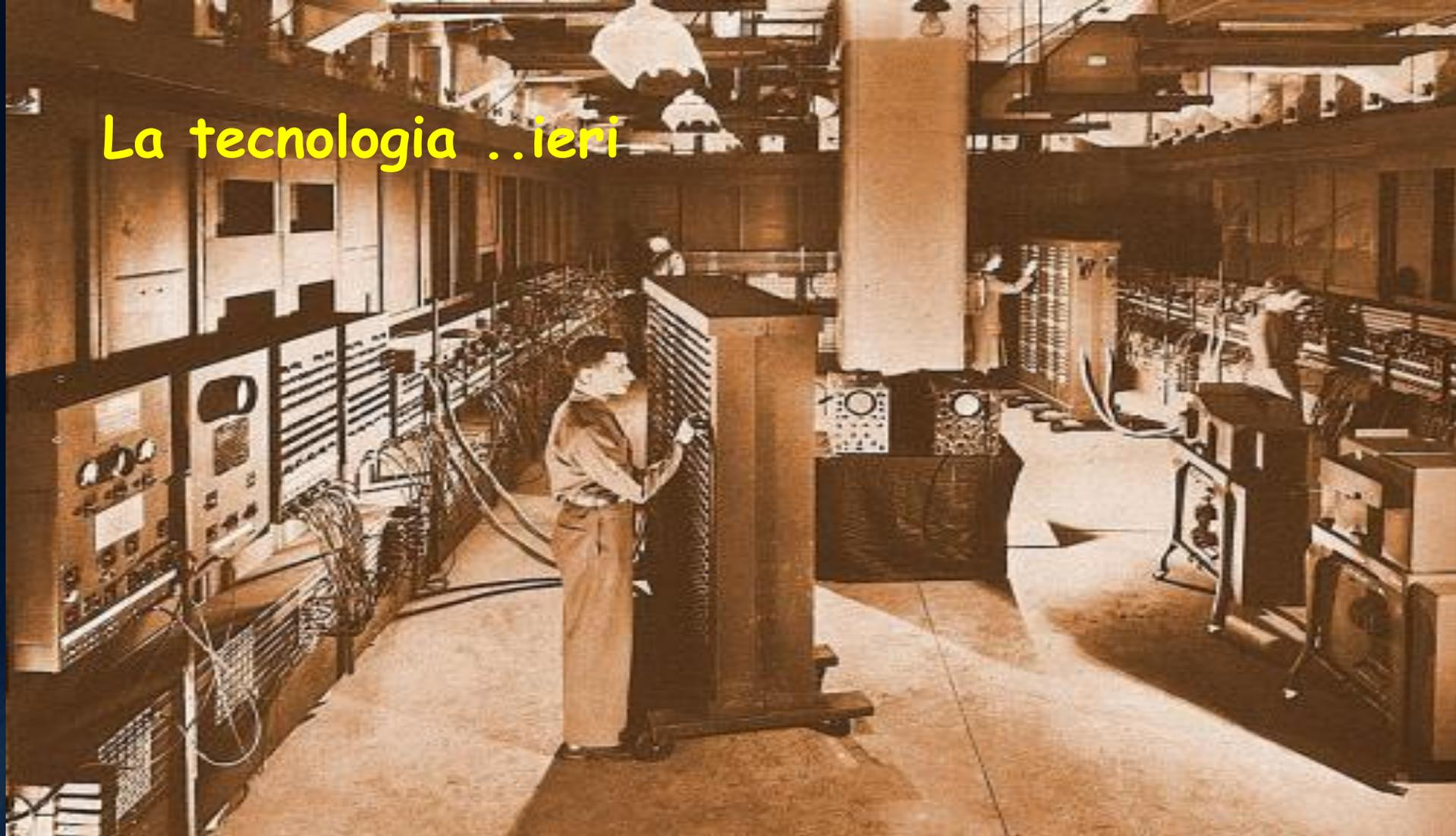
1946- ENIAC: il primo computer, 30 tonnellate, 17000 valvole...non esattamente un computer portatile
